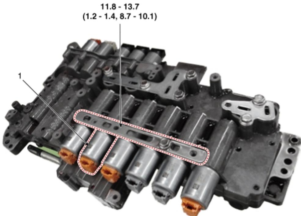
Tightening torque: N·m (kgf·m, lb·ft)
